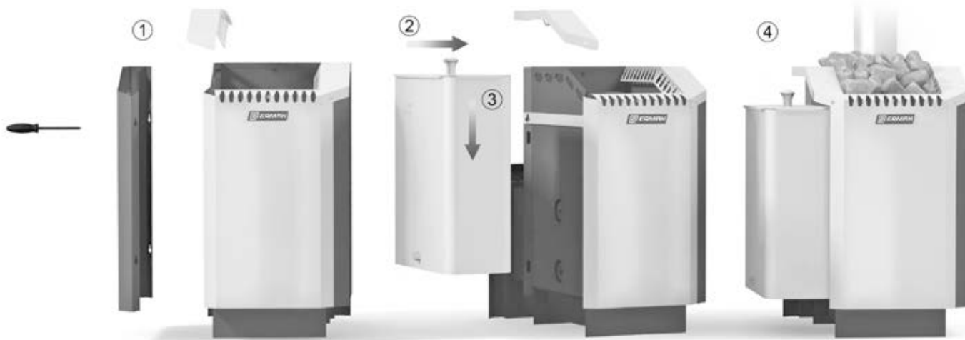
Рисунок - 8. Последовательность установки бака для нагрева воды
